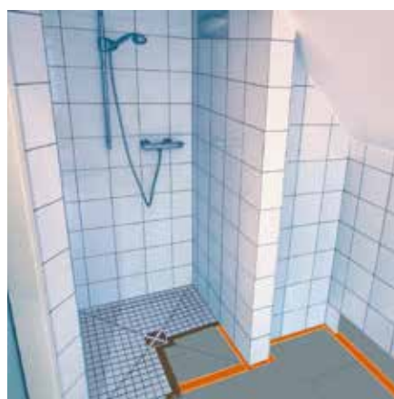
Afb. 7: Vloeroppervlakken kunnen worden uitgevoerd met fermacell Vloerelementen. Meer informatie vindt u in de brochure ' fermacell Vloerelementen - Systemoplossingen voor elke vloer'.
