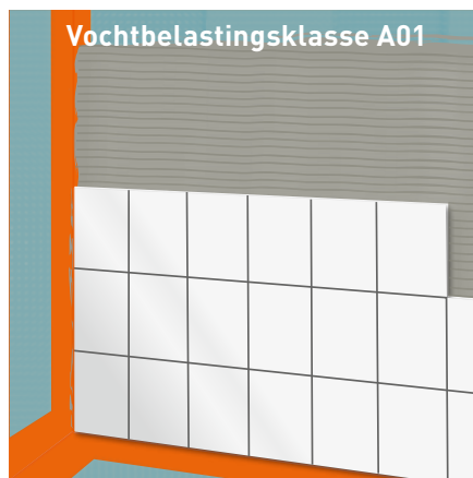
Afb. 4: Tegels worden in een dunne laag fermacell Flexibele tegellijm geplaatst (garandeert de afdichting voor de vochtbelastingsklasse A01). Ga door naar afbeelding 7.
