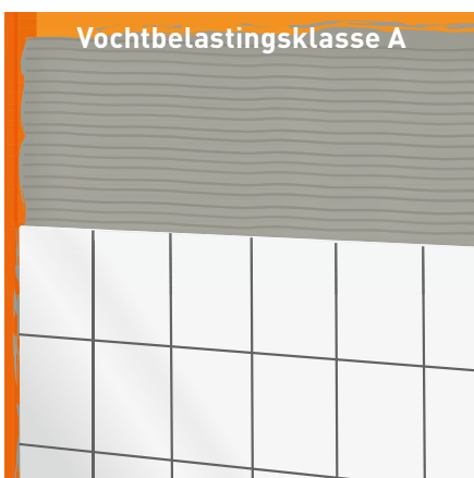
Afb. 6: Tegels worden geplaatst met een dunne laag fermacell Flexibele tegellijm op een volvlakse afdichting (garandeert de afdichting voor de vochtbelastingsklasse A)
