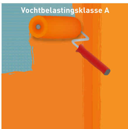
Afb. 5: fermacell Vloeibare folie met de rol in 2 lagen op het hele oppervlak aanbrengen (totale dikte ten minste 0,5 mm)
